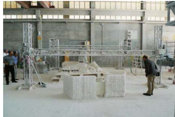
3Dプリンタ技術を使った拠点建設計画と実証実験 (Credit: ESA)
